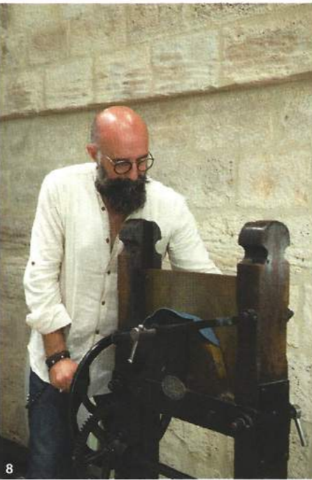
8 小さなギロチンのように上から革に型をつけるノロッキングの器具。革に水分などを含ませてから作業する。9 細い平のテープの両サイドを折ってフヤフヤするための器具。靴づくりのためにつくられた古い器具という。
